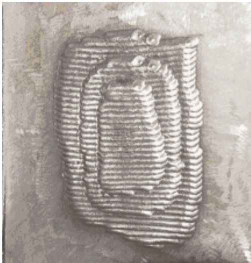
Figura 11: Corpo de prova preenchido com três camadas de solda auxiliado pelo OPENREIS.
